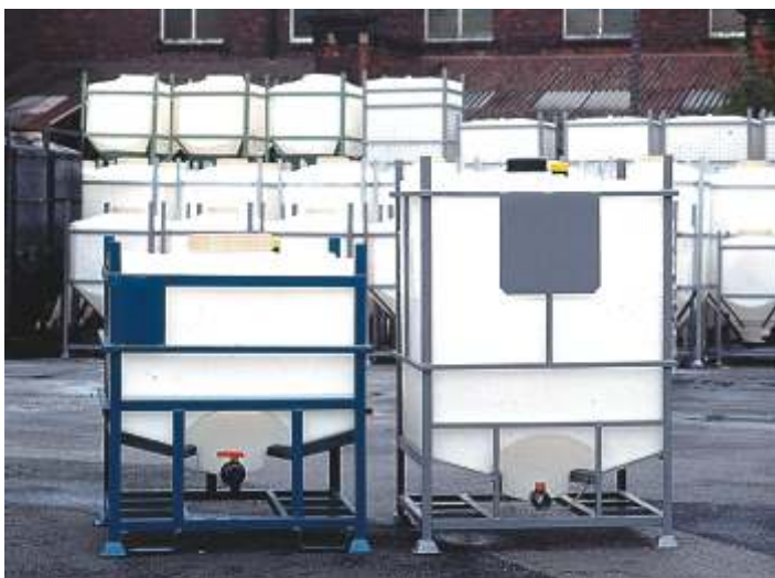
Maximover für Lebensmittelherstellung, um das Reinigen zu vereinfachen, wurden die Gestelle ohne Schutzgitter bestellt.
