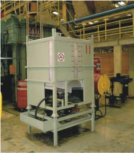
Maximover in der Produktion. Das Gestell wurde nach Kundenwunsch lackiert und voll verkleidet, für besseren Schutz.
