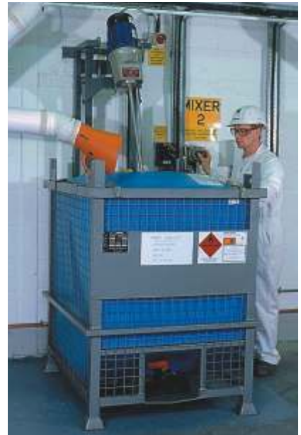
Auffüllen eines HLR 1000 Maximover mit Leim. Der Tank ist gefärbt um den Inhalt vor UV-Strahlen zu schützen.
